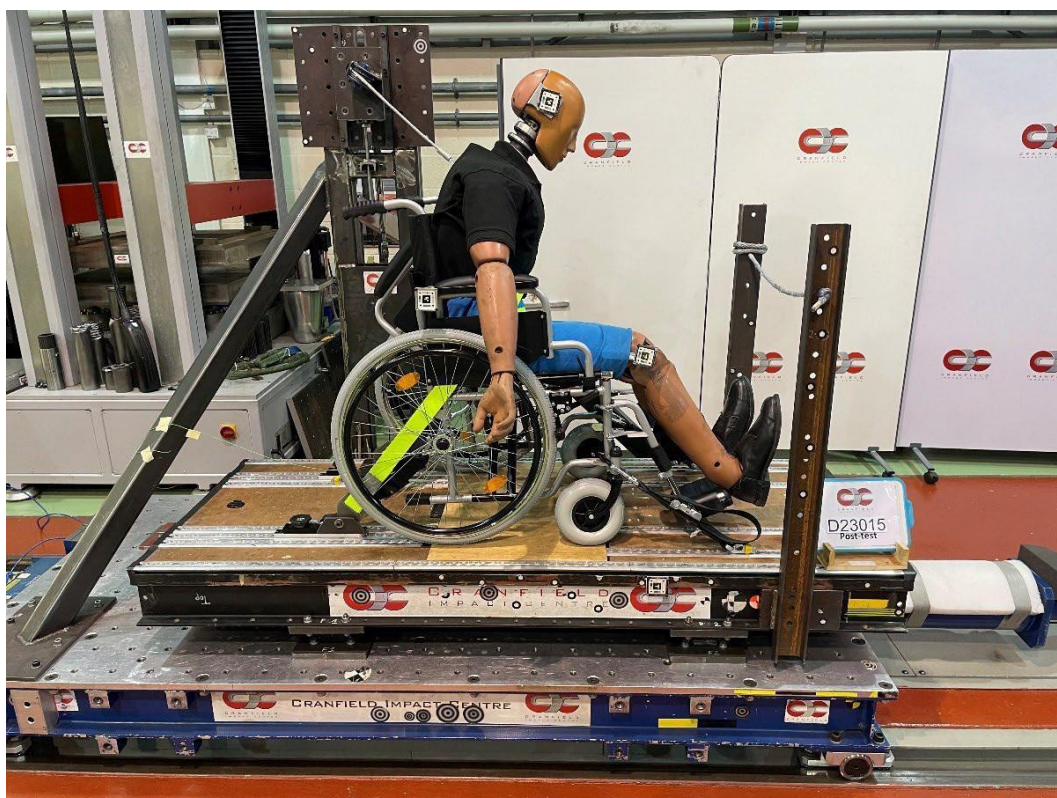
(Kolečkové křeslo 0811300 během nárazového testu)
